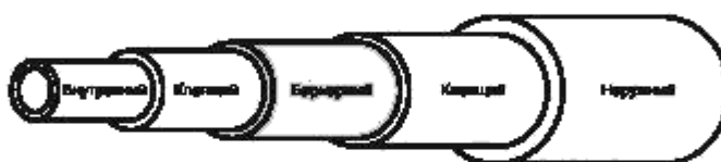
Рисунок 1 — Слои многослойной напорной трубы
